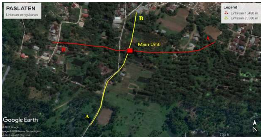
Gambar 1. Lintasan Pengukuran Metode Geolistrik di Desa Paslaten
