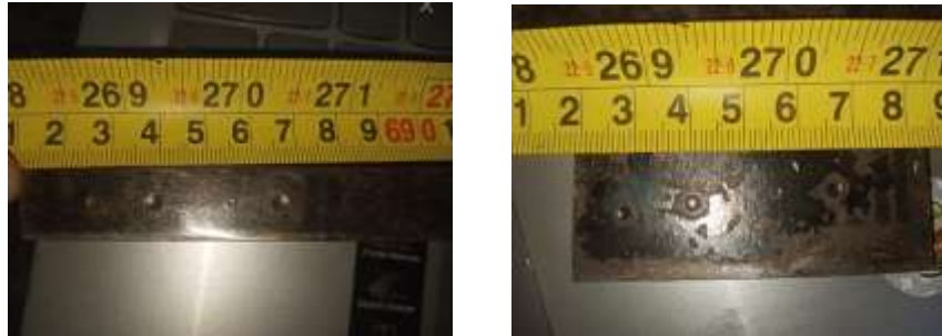
Gambar 4. Hasil percobaan indentasi specimen pembanding (kiri) dan uji (kanan).
