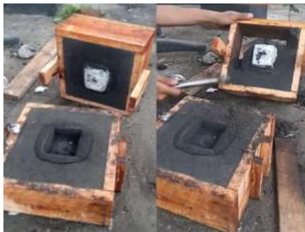
Gambar 7. Proses pembongkaran cetakan
