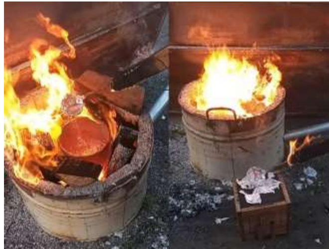
Gambar 6. Aluminium yang sudah cair dan proses pengecoran
