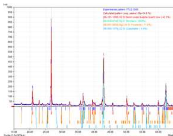
Gambar 5. Tampilan pola-pola difraksi sinar-x sampel FTLQ 1000 setelah dilakukan Search-Match
