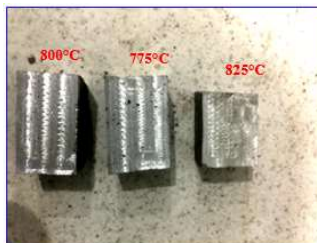
Gambar 6. Spesimen Uji Cacat Porositas
