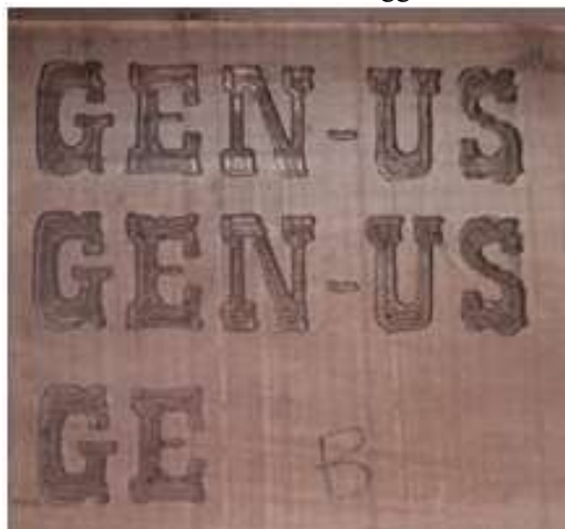
Gambar 11. Hasil visual mesin cnc menggunakan driver A4988
