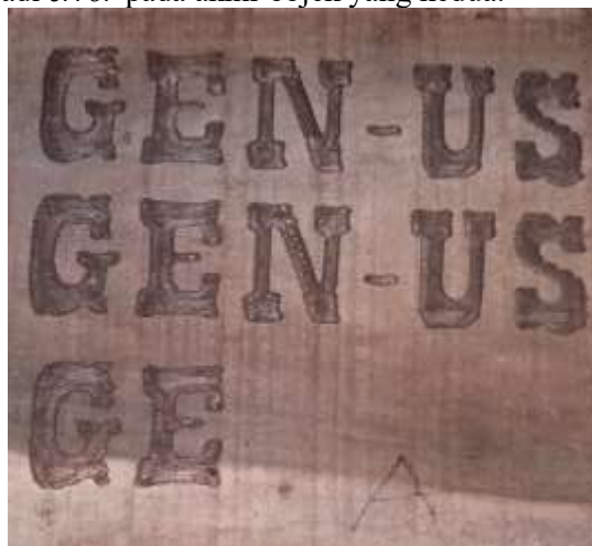
Gambar 10. Hasil visual mesin cnc menggunakan driver TB6560
