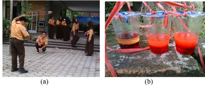
Gambar 7. (a) Salah satu siswa memperagakan cara kerja sentrifugasi, (b) hasil pemisahan campuran setelah cairan diputar
